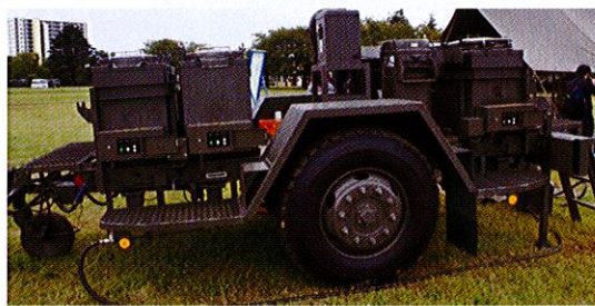
◇写真上は、一度に200人分の主食・副食を調理出来る「野外炊具1号」(22改)、右は切ったり皮を剥いたり珍しい、葉物・球根野菜の便利な調理機具だそうです。
